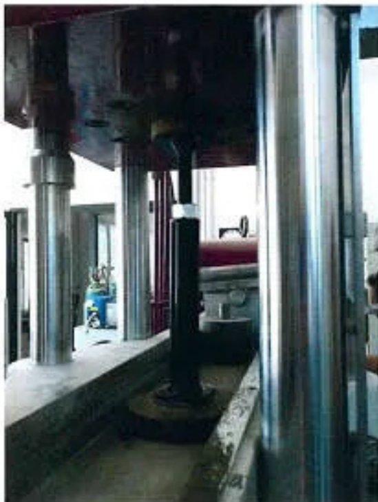
Vista del campione 2 durante la prova di compressione con estensione 30 cm
