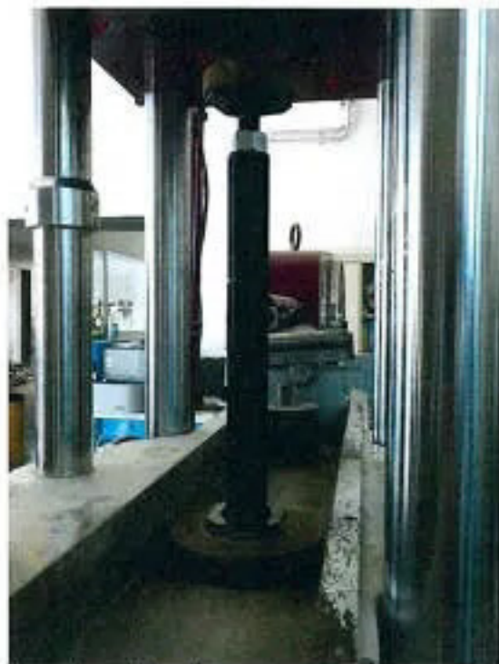
Vista del campione 3 dopo la prova a rottura con estensione 35 cm
