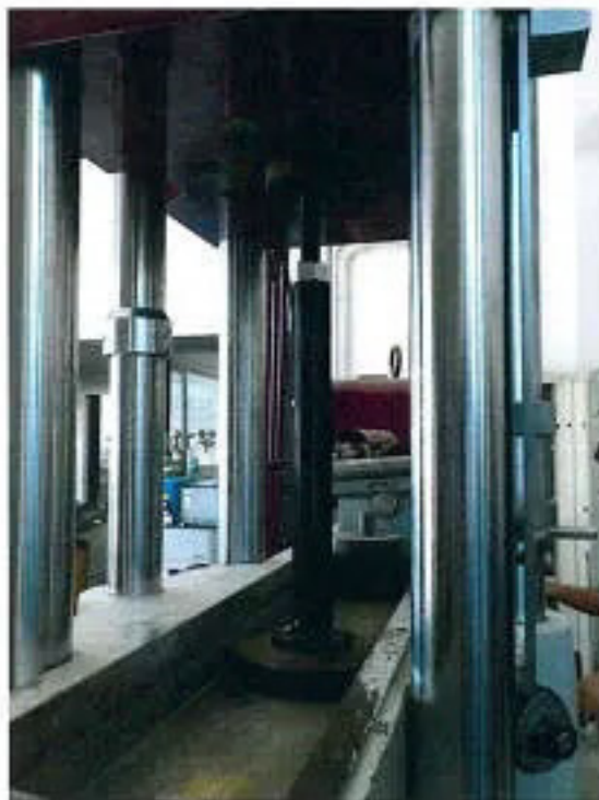
Vista del campione 4 durante la prova di compressione con estensione 40 cm
