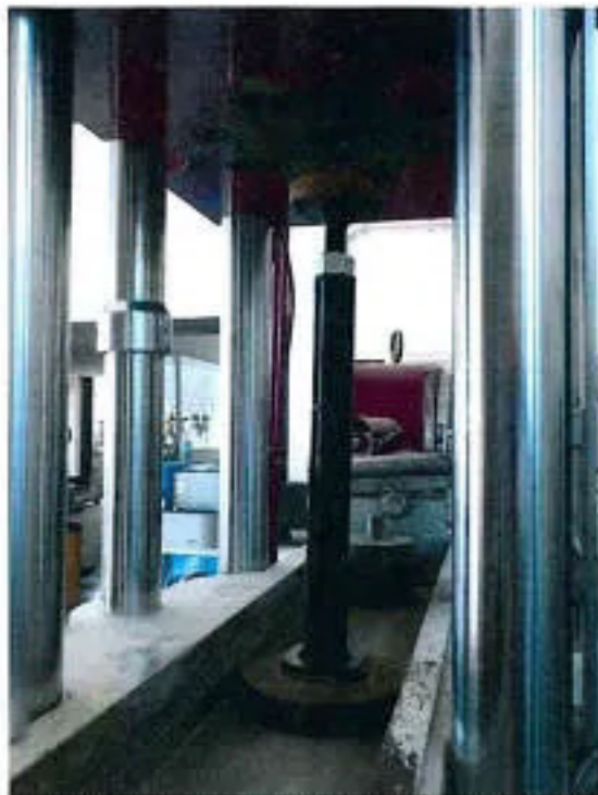
Vista del campione 2 durante la prova di compressione con estensione 35 cm
