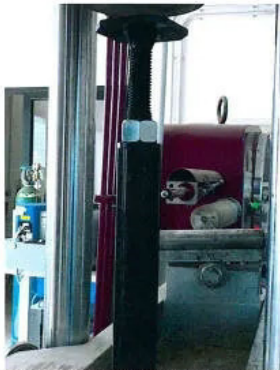
Vista del campione 2 dopo la prova di compressione con estensione 30 cm
