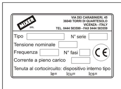
FIG.2 (Targa dati quadro elettrico)
