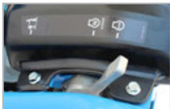
**Leva di accelerazione a 3 posizioni:** Sosta, marcia e spegnimento. Questo dispositivo evita l'ingolfamento del mezzo regolando il flusso del carburante in base alle esigenze dell'operatore.
