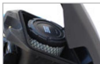
**Filtro dell'aria** posizionato in modo da poter essere facilmente controllato, pulito o sostituito.
