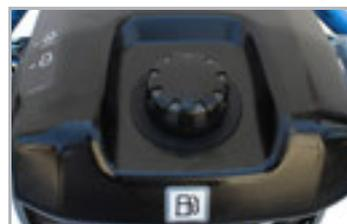
**Serbatoio della benzina stagno.** Searammer 70 può essere coricato durante il trasporto senza causare perdite.
