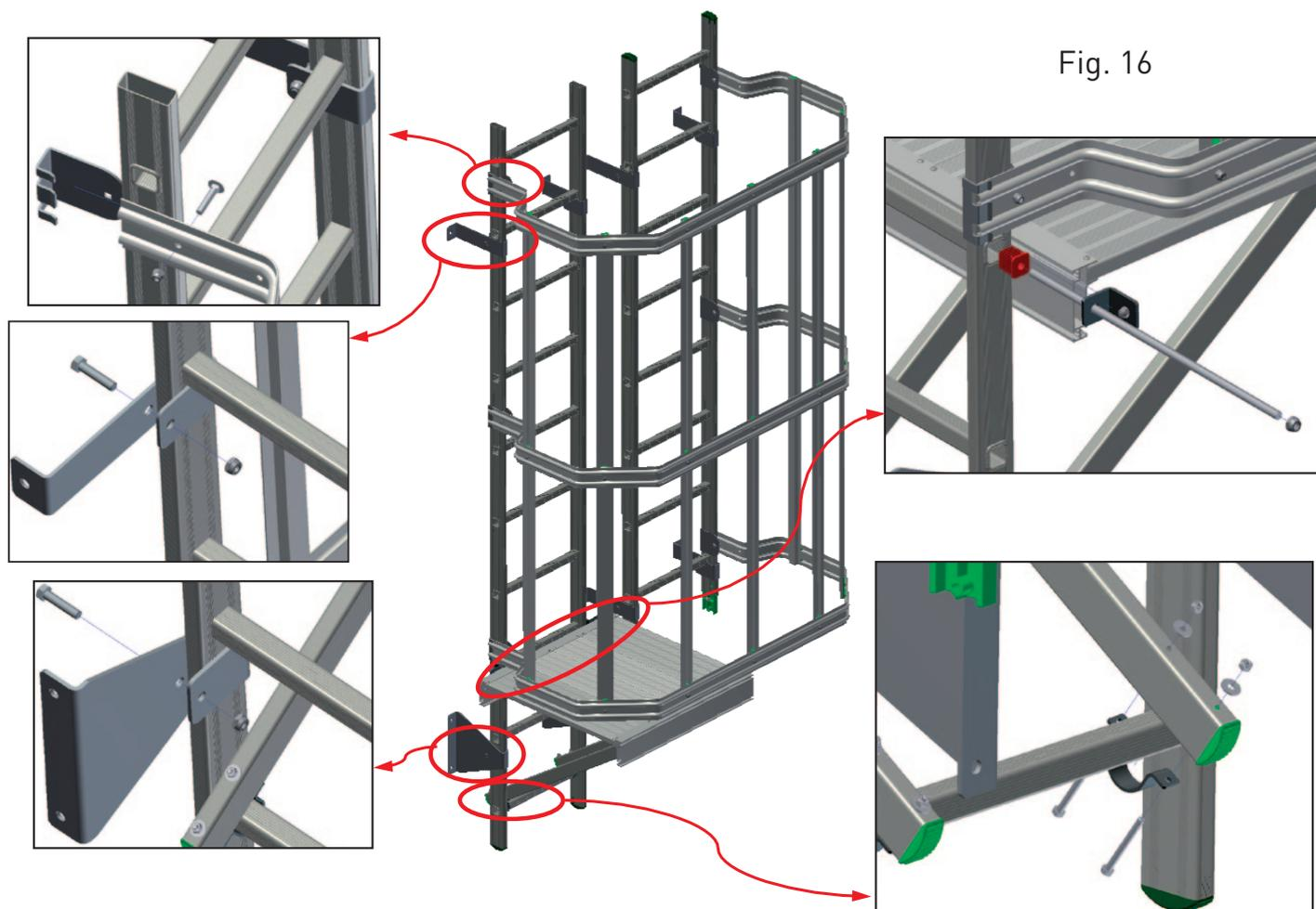
Una volta montati i vari moduli a terra è possibile innestare dall'alto i moduli completi di gabbia e zanche di fissaggio e fissarli a muro.
